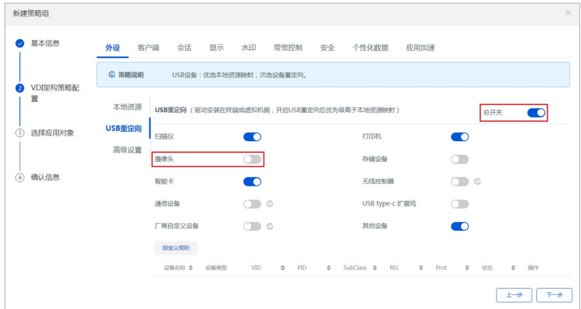
图3-3 启用本地资源映射的摄像头重定向-禁用 USB 摄像头重定向
